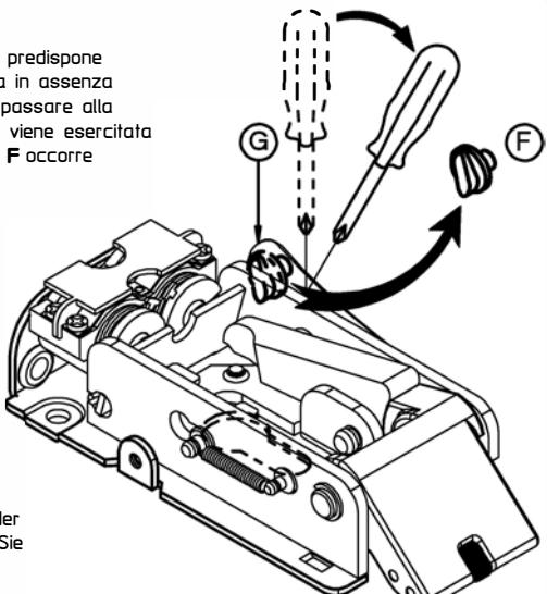
**I**) SERRATURE ELETTRICHE V06 - Installazione verticale
